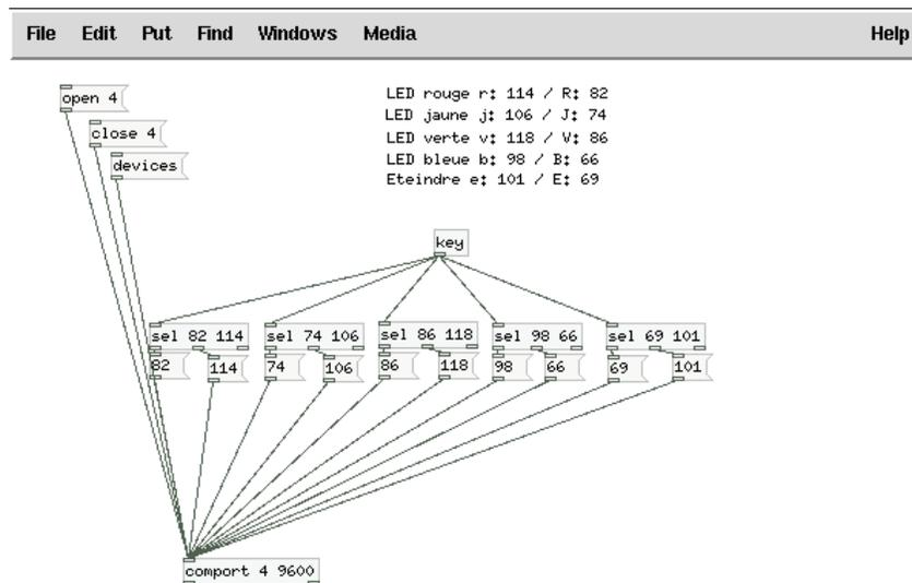
L'image ci-dessus est celle d'un programme Pure Data destiné au pilotage des LED connectées à la carte, lancer-le après avoir connecté la carte Arduino à l'ordinateur et téléversé le code ci-dessus.
