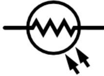
La cellule photoélectrique, ou photorésistance, est un semi-conducteur à résistance photo-variable. Elle permet de détecter et/ou mesurer la lumière.
