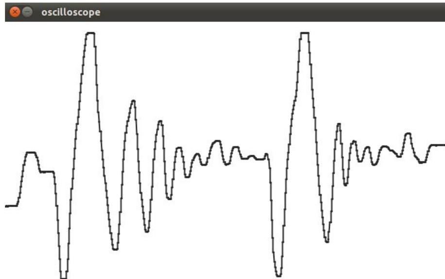
La courbe affichée dépend du circuit que vous mesurez avec l'oscilloscope. Si vous n'avez rien de spécial à mesurer, vous pouvez essayer avec un potentiomètre, en prenant la mesure sur sa patte du milieu, et en reliant les deux autres bornes respectivement au GND et au 5 V.
