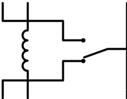
Le relais est un interrupteur électromécanique, ce qui signifie qu'il change de position ou d'état grâce à un électroaimant. Il peut donc être commandé par un signal électrique dans un circuit. Le relais est utilisé pour relayer une commande sur un circuit de plus forte puissance (voir chapitre « Précautions d'utilisation »). Comme l'électroaimant contient une bobine, il est nécessaire d'utiliser une « diode de roue libre ».
