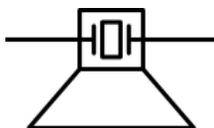
Le piézoélectrique est un composant réversible qui génère une tension quand il est déformé et qui se déforme lorsqu'il est soumis à une tension. Il prend souvent la forme d'une pastille qui peut alors servir à la fois de micro-contact et de haut-parleur. Il peut ainsi servir d'interface humain/machine. Le signal sortant d'un piézo est assez erratique.
