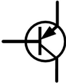
Le transistor est une association de trois couches de semi-conducteur et dont la couche du milieu sert à contrôler le passage du courant dans les deux autres. Il s'agit d'un composant actif qui est souvent utilisé comme interrupteur ou amplificateur, à la manière d'un relais. Il existe différents types de transistor au comportement différent, les NPN et PNP, les transistors à effet de champ, ou MOSFET.
