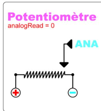
Nous pouvons par exemple reproduire ce principe avec une trace de crayon-gris déposée sur du papier en guise de résistance sur laquelle nous déplacerons un fil électrique connecté à une entrée analogique de l'Arduino. Les deux extrémités de la trace devront être connectées aux bornes positives et négatives de l'Arduino. Nous pouvons aussi utiliser une feuille de papier noir dont la couleur est généralement fabriquée à partir du carbone pour obtenir le même effet.
