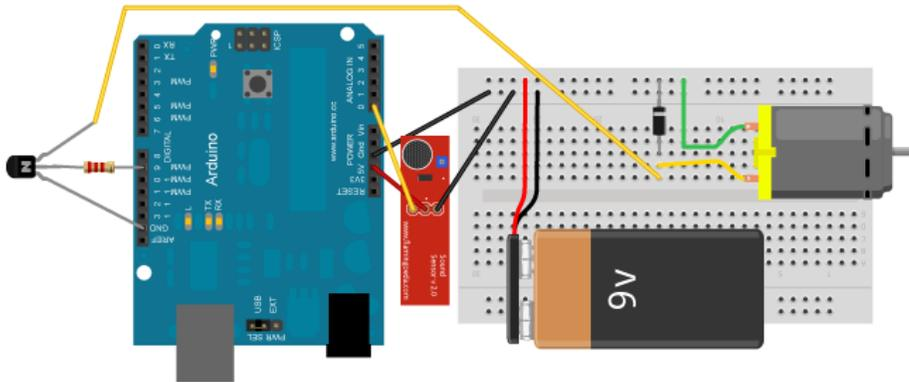
À présent, il nous faut incorporer notre capteur de souffle au circuit. Notez que vous pouvez utiliser un potentiomètre pour simuler ce capteur et réaliser le projet. Il est toutefois inutile de souffler sur le potentiomètre, il ne réagira pas! Le capteur que nous utilisons ici a trois fils. Le fil négatif (-) doit aller à la *pin* Gnd de l'Arduino. Le fil positif (+) doit être connecté à la *pin* 5V de la carte Arduino. Finalement, le fil du signal doit être connecté à la *pin* 0 de l'Arduino.
