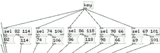
L'objet « key » lit le caractère saisi au clavier et renvoie sa correspondance en chiffre. Les valeurs correspondantes aux caractères indiqués dans le principe de fonctionnement sont sélectionnées avec l'objet « sel » et envoyées à l'objet « comport ».
