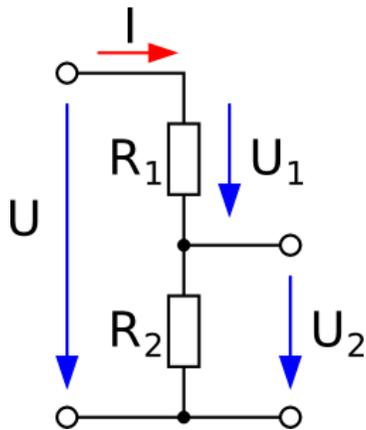
Ce circuit est très utile pour réduire une tension. Dans un pont diviseur, la tension aux bornes de la seconde résistance est proportionnelle au rapport de celle-ci par rapport à la résistance globale du circuit. Dans la métaphore de l'eau, les deux résistances constituent un escalier ou une cascade. Sa fonction est :
