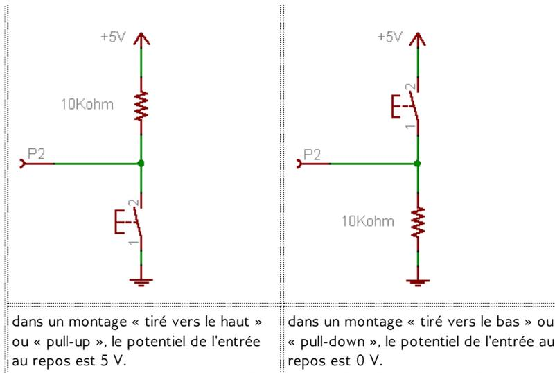
Les sorties numériques peuvent actionner de nombreux composants (LED, transistor, etc.) mais elles ne peuvent pas fournir beaucoup de courant (40 mA pour une carte Arduino UNO). Pour piloter des circuits de plus forte puissance, il faut passer par des transistors ou des relais (voir chapitre « Précautions d'utilisation »).
