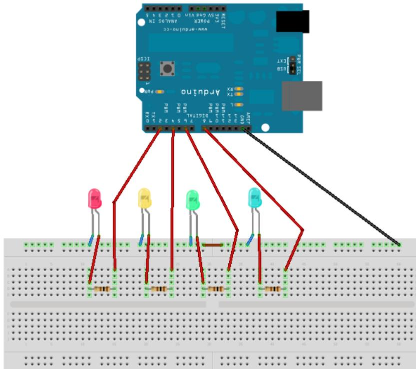
Les LED, leur résistance appropriée et le fil de connexion sont montés sur la platine d'essai. L'anode (patte positive) de chacune des LED est connectée à une résistance reliée à une pin numérique de la carte: la LED rouge est reliée au pin 2, la jaune au pin 4, la LED verte au pin 6 et la LED bleue, au pin 8.
