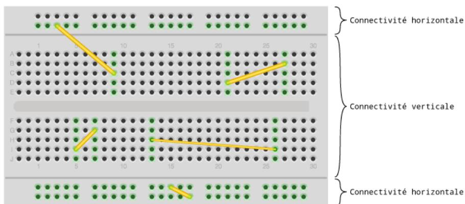
À ce stade, les connexions doivent être faites avec des fils électriques mono-brin dont l'aspect est rigide. Par précaution vous pouvez utiliser votre voltmètre pour tester la continuité des connexions qui vous semblent défectueuses. Pour cela il faut utiliser la fonction « test de continuité » symbolisée par un logo qui illustre des ondes sonores.
