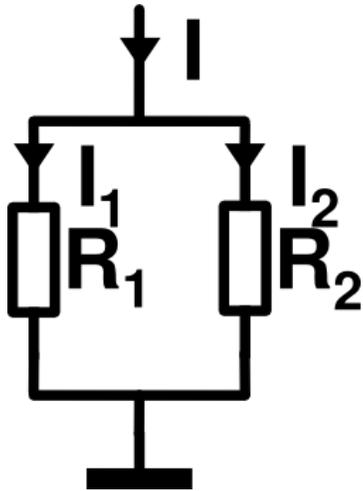
Ce circuit est le pendant du pont diviseur de tension. Lorsqu'on branche deux résistances en parallèle, le courant se partage entre les deux branches proportionnellement au rapport des valeurs des résistances. Sa fonction est :
